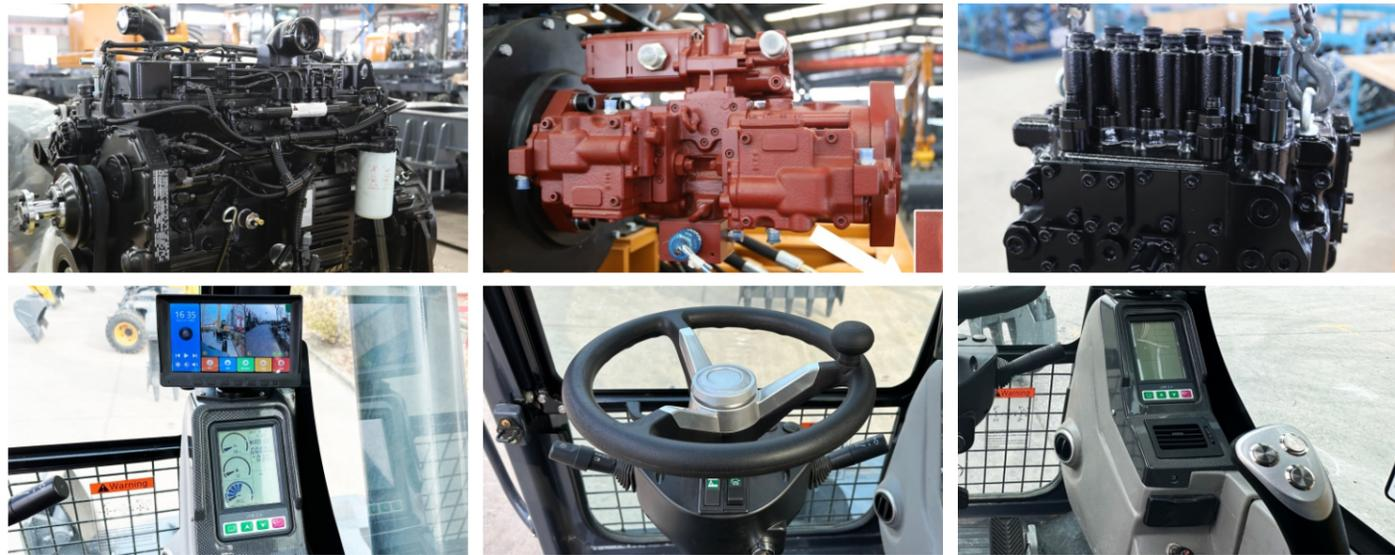
恒特HT215K挖掘机是帝盟重工自主研发的新一代全液压升降驾驶室轮式挖掘机，采用高功率低油耗的国四标准电喷发动机，保证了整机的强劲动力和功率储备；高效液压系统与桥箱的精确匹配，确保了工作状态和行走状态的随意切换；整机液压系统匹配进口液压部件，具有“动作协调、可靠性高、安全环保、舒适便捷”等特点，同时可根据客户需求提供定制化要求配置，可适应不同国家及客户的需求。
